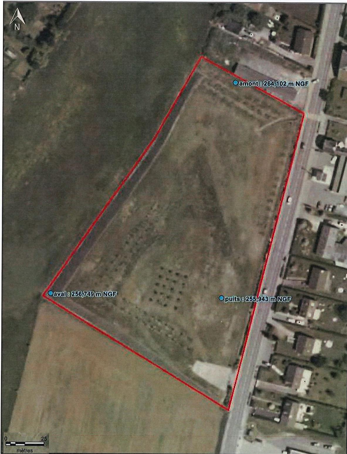
Figure 14 : Niveaux d'eau mesurés sur les ouvrages présents dans la zone d'étude
